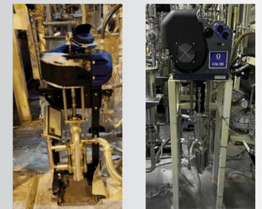
Le givrage se produit lorsque l'humidité présente dans les conduites d'alimentation en air se condense et gèle sur les commandes pneumatiques. Si la glace accumulée fond dans les récipients de matériaux, elle peut provoquer des problèmes de contamination. Si la glace fondante goutte sur le sol de l'usine, elle représente un risque pour la sécurité.
